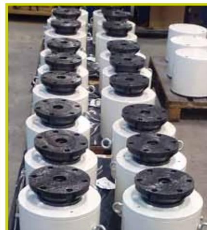
Cilindros de doble efecto con recubrimiento cerámico y cabeza basculante.
