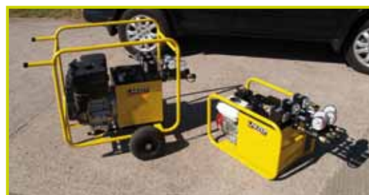
Grupos de gasolina para trabajar en aplicaciones de encarrilamiento de trenes.
