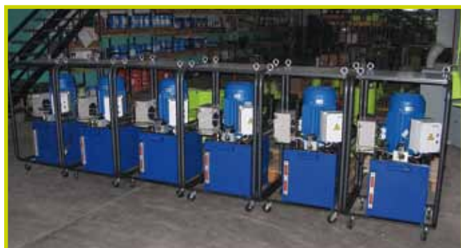
Grupos hidráulicos de 50 litros con intercambiador de calor, cuadro protector y ruedas.
