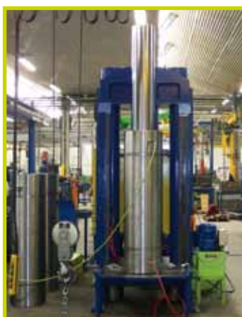
Cilindro de doble efecto de 500 Tn y 1.250 mm de carrera.
