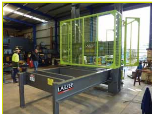
Prensa de columna móvil de 200 Tn .
