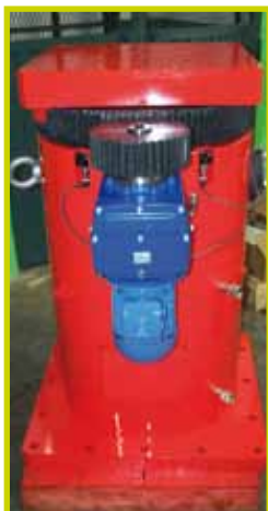
Cilindro de doble efecto con engranaje, tuerca motorizada, sensor de proximidad para tuerca y sensor de carrera.
