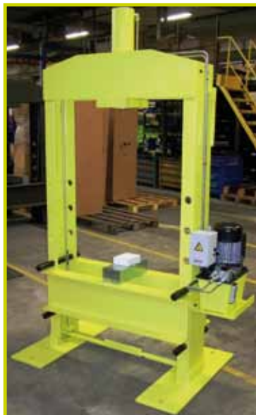
Prensa de doble efecto de 50 Tn y 370 mm de carrera con grupo eléctrico.
