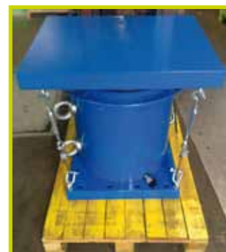
Cilindro de 1.000 Tn de simple efecto con tuerca de bloqueo y cabeza basculante. Soporta una carga lateral del 12%.
