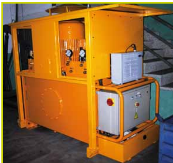
Sistema de Elevación Sincronizado con depósito de 1.000 litros. Con 2 salidas sincronizadas + 2 salidas manuales. Caudal: 25.5 l/min.
